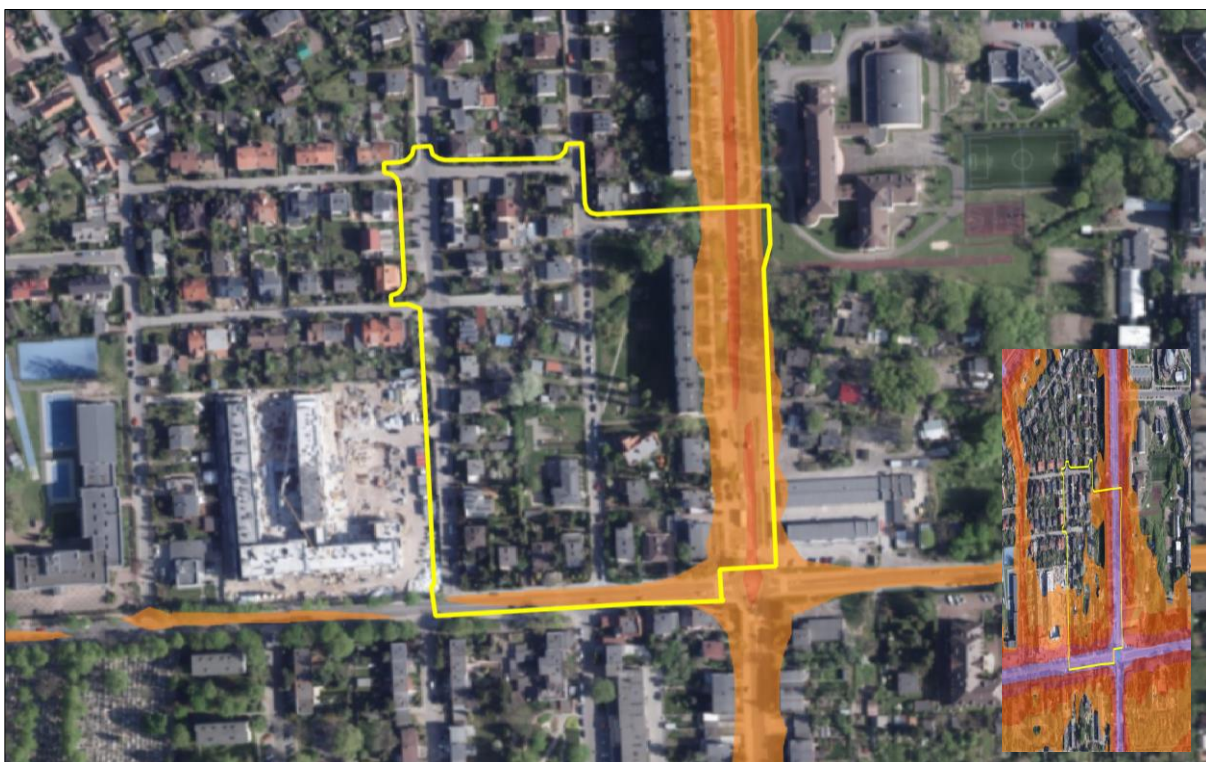
Rysunek 8. Przedziały hałasu drogowego w porze L_n (zasięg obszaru projektu planu zaznaczono żółtą linią; źródło: mapahałasu.torun.pl)
