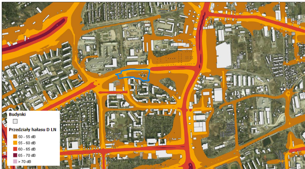
Rysunek 9. Przedziały hałasu drogowego w porze L n (zasięg obszaru projektu planu zaznaczono niebieską linią; źródło: mapaakustyczna.um.torun.pl)
